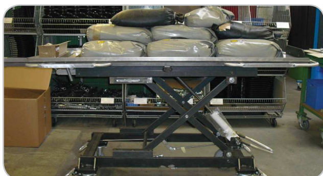
statischer Belastungstest am Prototypen
